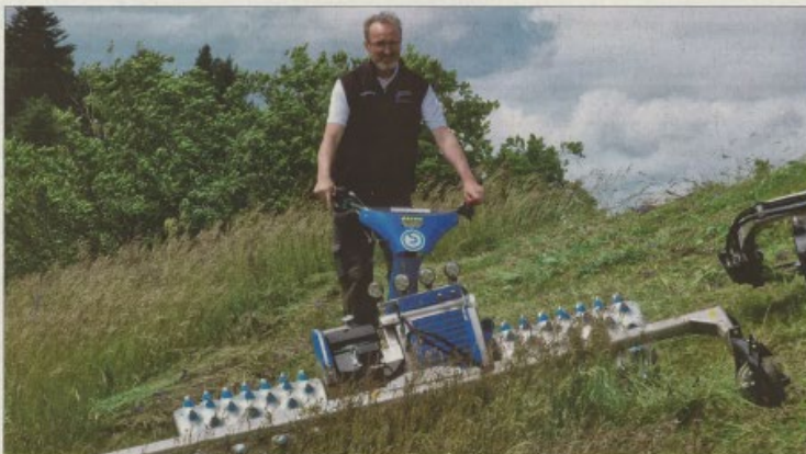
Heinz Zaugg im Einsatz mit einem Mäher von Brielbauer. Diese sind eigens für den Einsatz in steilen Lagen ausgelegt, punktieren aber auch mit einbaubarer Bodenbarkel. Bewegen kann man diese Mäher bei mir zu Hause in Emmenetal gar «Frauenflöhen», scherzte Zaugg.
